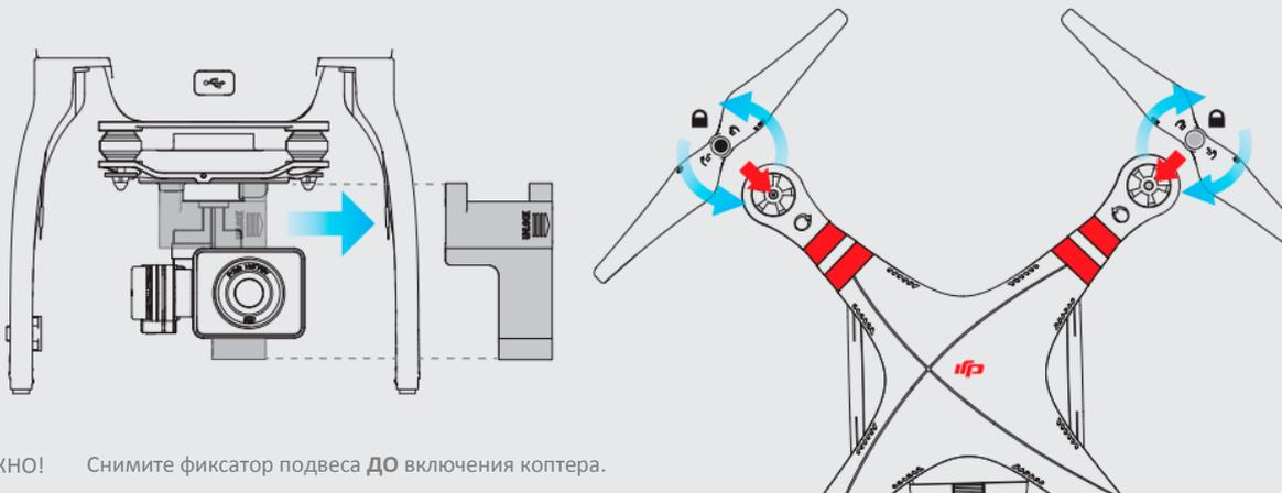
**⚠ ВАЖНО!** Снимите фиксатор подвеса **ДО** включения коптера.
